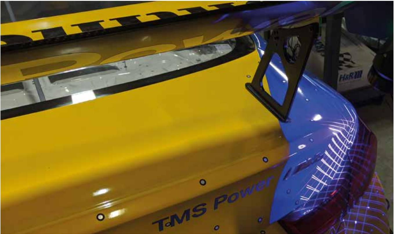
Vom Laserscan zum 3D-Modell – der BMW M4 GT4 basiert auf realen Daten und nimmt langsam aber sicher Form an.
