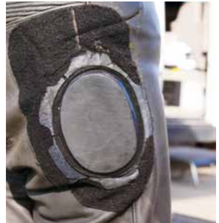
Schleifpads mit Kampfspuren.
