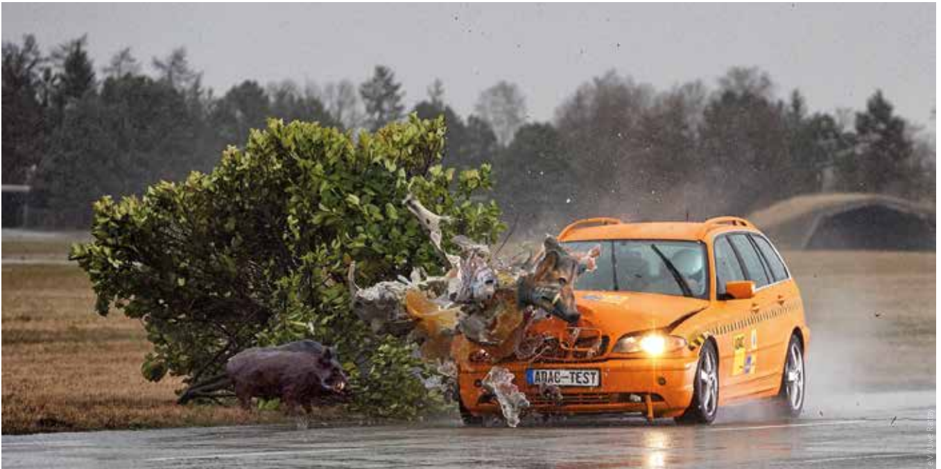
Der ADAC Crashtest mit einem Wildschwein-Dummy zeigt: Auf das Fahrzeug und die Insassen wirken enorme Kräfte ein.
